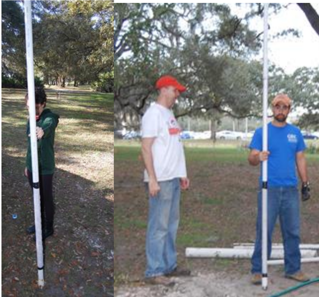
Photo 1 et 2: Tuyaux PVC, pret avec son filtre bien attache, et son point en bas
